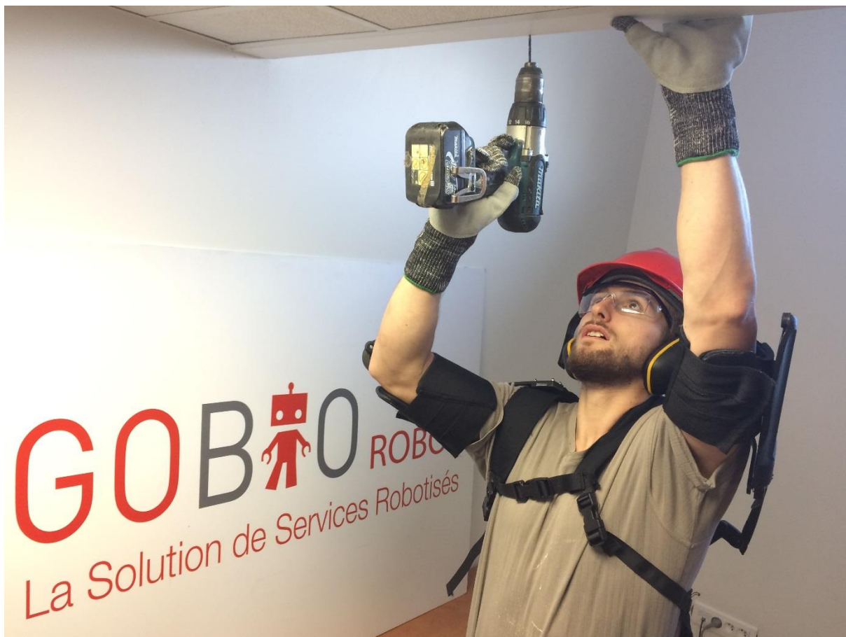
Ergosquelette EXO IP12 – exosquelette de posture – aide aux travaux manuels en hauteur. ©GOBIO
